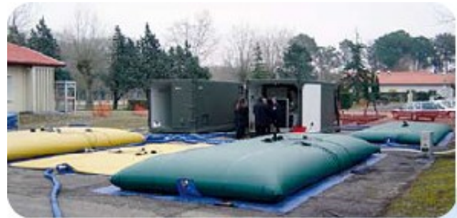
Illustration 17: Citernes souples utilisées par l'armée française dans des unités mobiles de traitement de l'eau (source CITAF)
