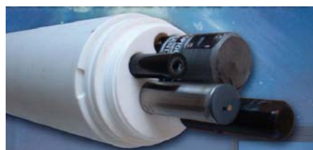
Figure 24 : Multiparameter probe (nke MP5)
