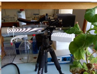
Système d'analyse et d'acquisition de la fluorimétrie de type PAM
