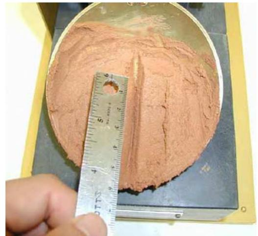
Photo 6 : Appareil de Casagrande
