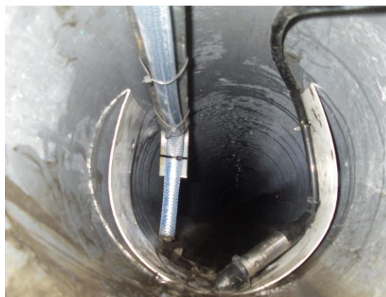
Figure 11: Photo du dispositif de prélèvement avec une sonde piézométrique
