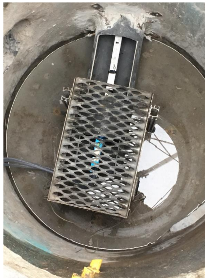
Figure 28: focus sur le point de mesure avec le débitmètre bulle à bulle – point 198
