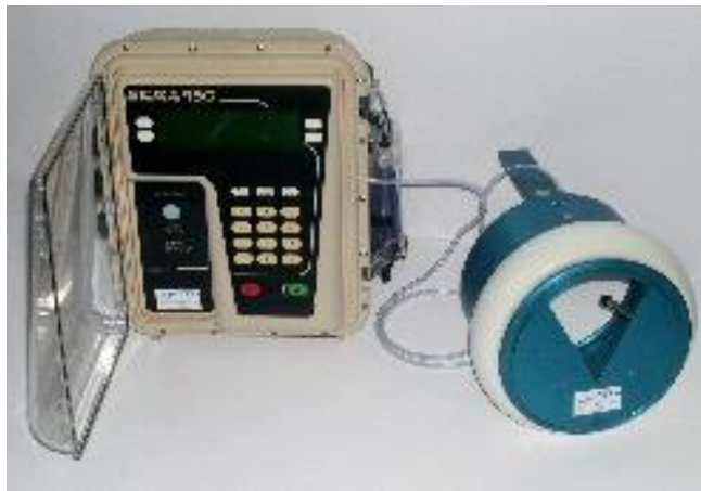
Figure 26: Obturateur déversoir avec mesure de hauteur/débit via le débitmètre bulle à bulle sigma 950 (HYDREKA)
