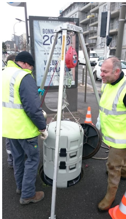
Figure 32: Photo prise lors de la mise en service du préleveur. Nécessité d'un treuil et d'une équipe « prélèvement » pour récupérer les flacons
