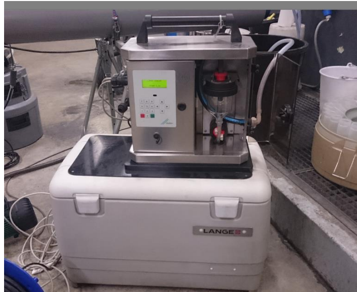
Figure 23 : Photo du préleveur Bülher 1029 avec embase réfrigéré
