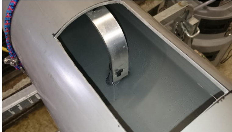
Figure 31: photo – illustration du dispositif de prélèvement au niveau de la canne de prélèvement (photo réalisée sur banc d'essai))
