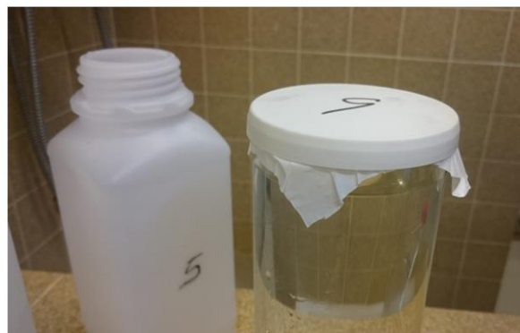
Figure 25: Photo des flacons plastique (1L) et verre (900 ml) avec membrane de Téflon
