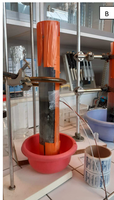
Figure 2 – A) Carottage manuelle en lac (source : Universal Core Head Kit). B) Carotte sédimentaire obtenu en 2019 de l'étang de Bailly. Le sédiment est dans la partie inférieure de la carotte en gris et noir et dans la partie supérieure l'eau recouvrant les sédiments.
