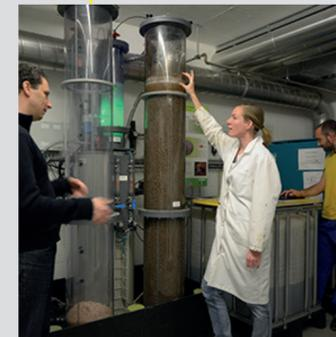
Procédé VUNA : nitrification + charbon actif + distillation. Installé en sous-sol du bâtiment de l'EAWAG.
