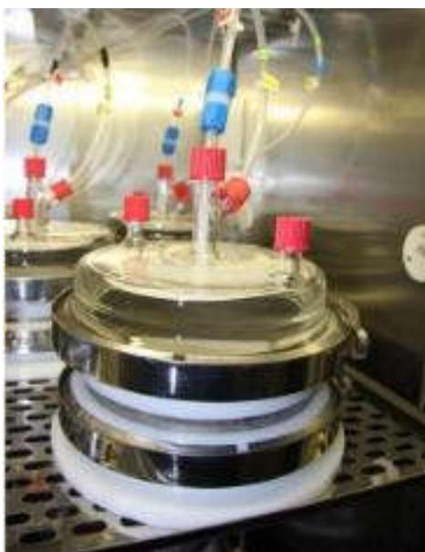
Figure 4.5. Dispositif de mesure de la volatilisation en caisson
