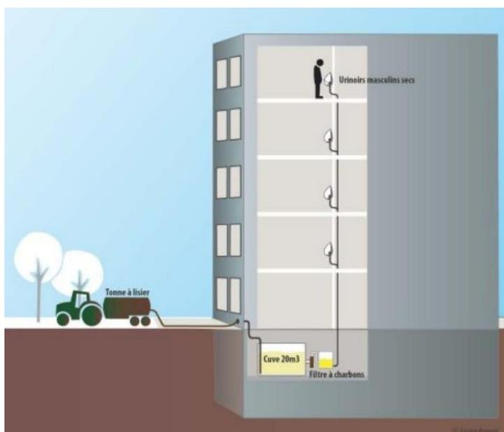
Figure 3. Le dispositif de collecte séparative des urines prévu sur le bâtiment tertiaire du lot C1.5B
