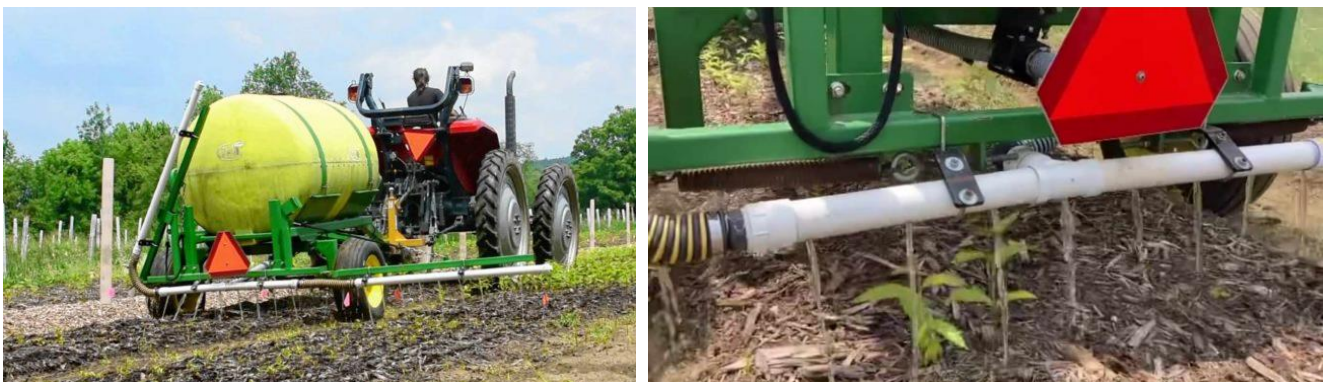
Figure 76: Photos de l'épandeur à lisain auto-construit du Rich Earth Institute, en cours d'utilisation. Source : Rich Earth Institute.
