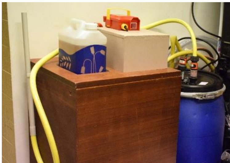
Figure 7 : Point d'apport volontaire d'urine au LEESU et prototype de système de transvasement.
