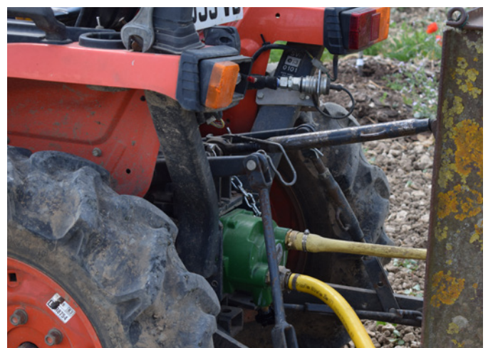
Motopompe reliée à la prise de force du tracteur (modèle Feroni MLI. 25)
