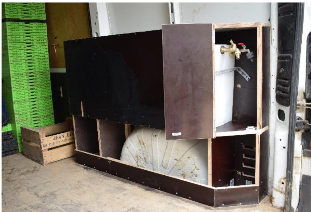
Figure 62 : Installation de la cuve d'urine dans le camion de la ferme partenaire du projet, protégée d'un caisson.
