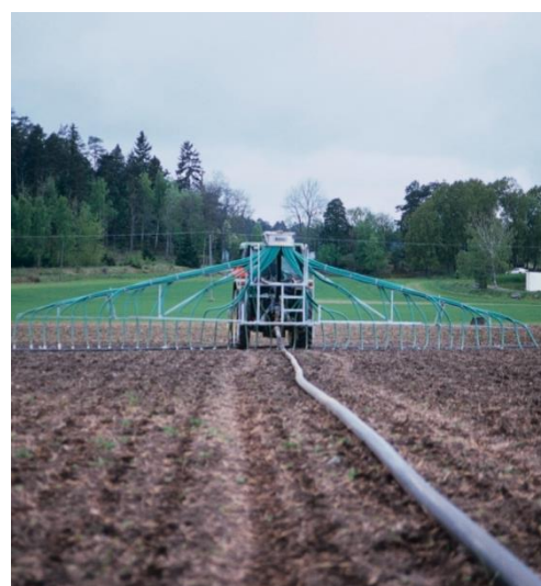
Figure 74 : Épandage de lisain « sans tonne », avec épandeur à ombilic, en Suède. Photo extraite de (35).
