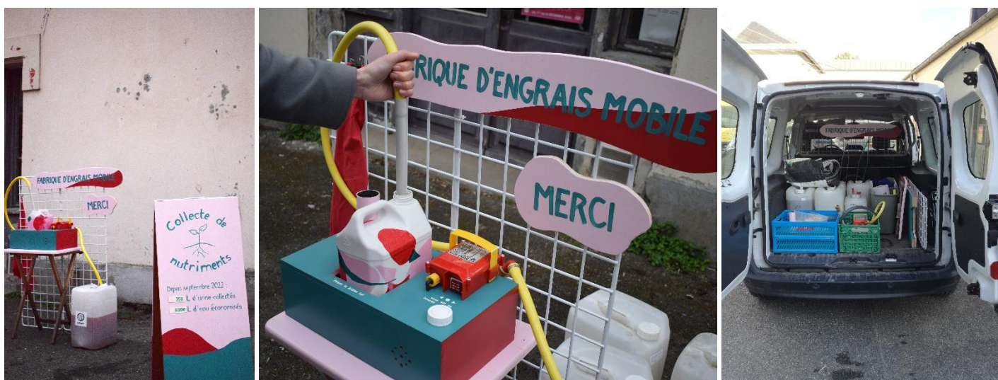
Figure 58 : De gauche à droite : station mobile de collecte d'urine installée sur le parking avec panneau d'accueil et de suivi des volumes collectés ; détail de l'interface d'utilisation pour transvaser les bidons de 5L des habitants vers les bidons de 20L ; station mobile repliée et bidons d'urine de 20L qui seront apportés à la ferme ultérieurement, stockés à l'Ecole des Ponts en attendant.
