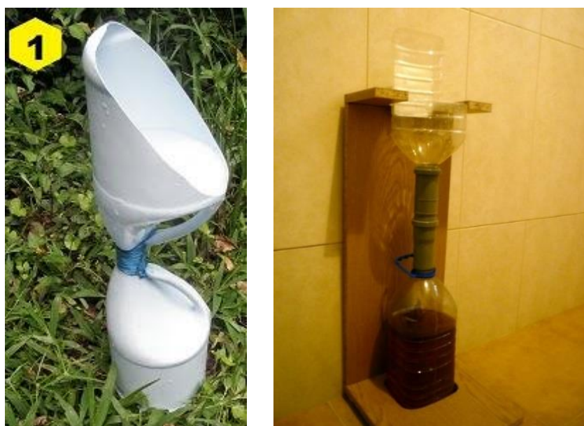
Figure 22 : A gauche, bidon découpé pour faire un entonnoir utilisable par les femmes (à porter à la main et approcher de sa vulve). Source : Chris Canada ( https://inodoroseco.blogspot.com/ ). A droite : Deux bouteilles en plastique de 5L assemblées par des éléments en PVC et support en bois pour maintenir le système en place. Source : Susana Forum ( https://forum.susana.org/172-urinals/6679-simple-urine-valves-to-control-odour-on-waterless-urinals-or-on-urine-diversion-toilets?start=12 )
