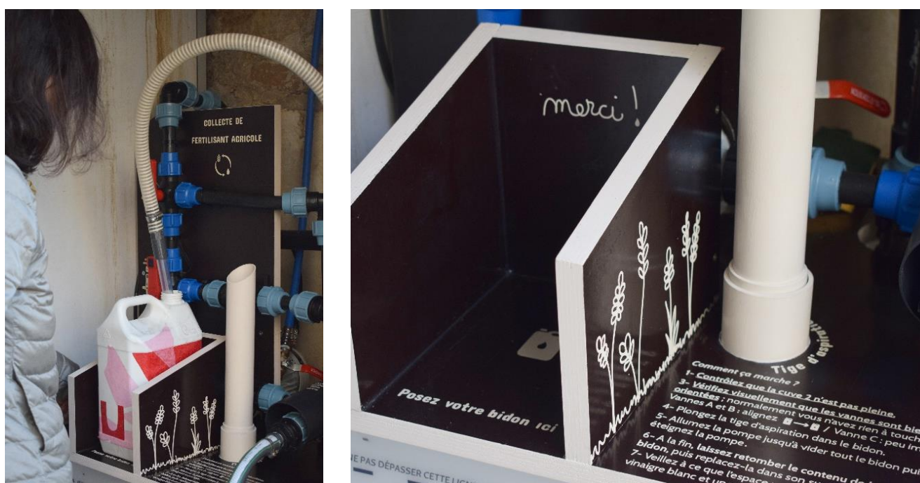
Figure 55: Station de transvasement en cours d'utilisation et vue de détail de l'interface usager.
