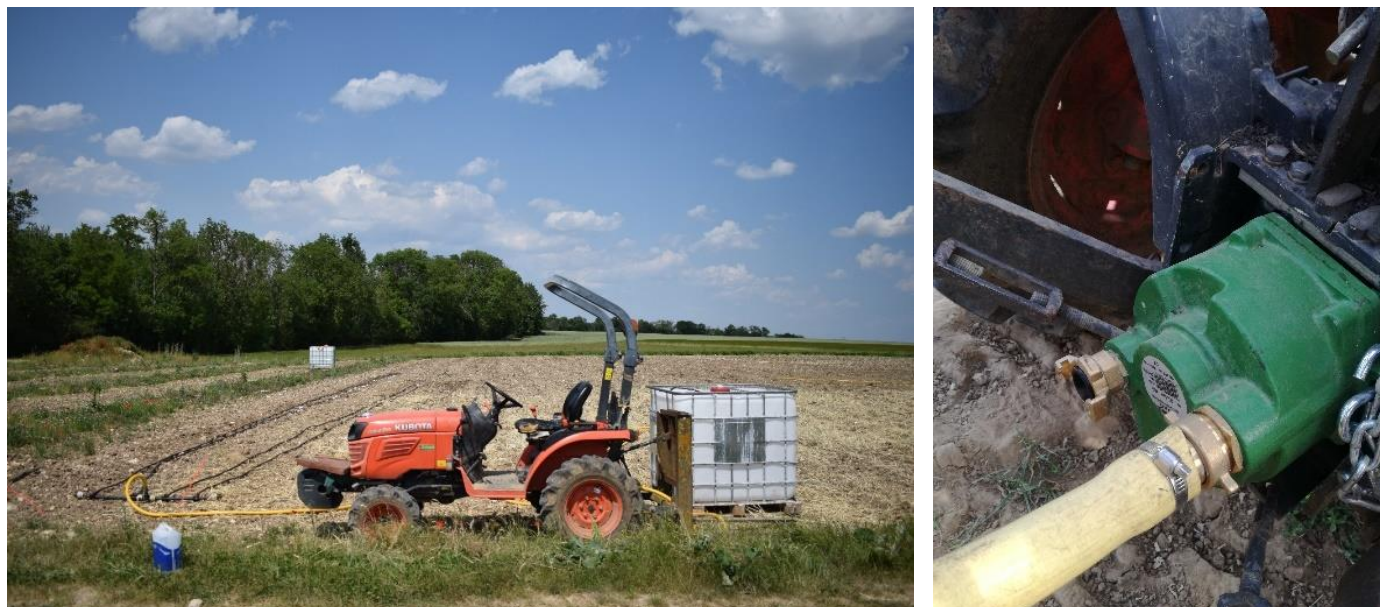
Figure 90 : A gauche : fertilisation d'une bande de Miscanthus par goutte-à-goutte (lisain dilué à 15% appliqué à 20L/m 2 ), en utilisant la motopompe. A droite : motopompe reliée à la prise de force du tracteur.
