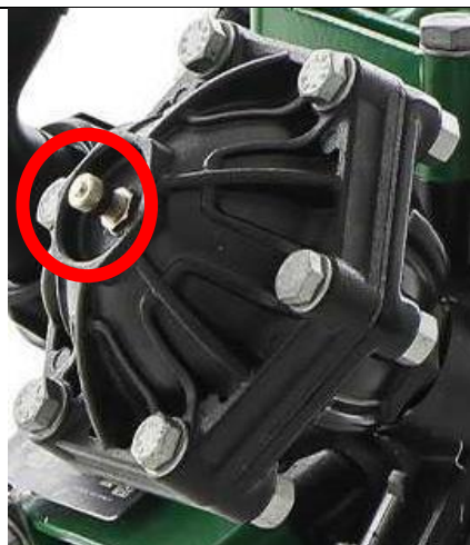
Figure 5 Accumulateur de la pompe Zeta 100 et la vanne de gonflage (en rouge)
