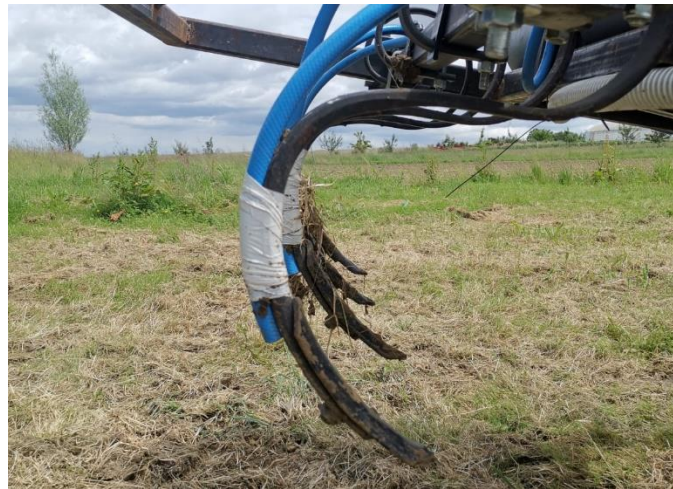
Figure 6: Dents du Pipiculteur et tuyaux d'épandage accrochées au "gaffer"
