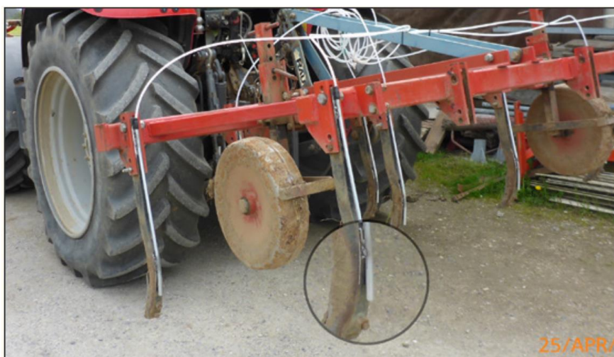
Figure 9 Dents avec injecteurs. Crédit : Eco-Dyn (Eco-Dyn s. d.)
