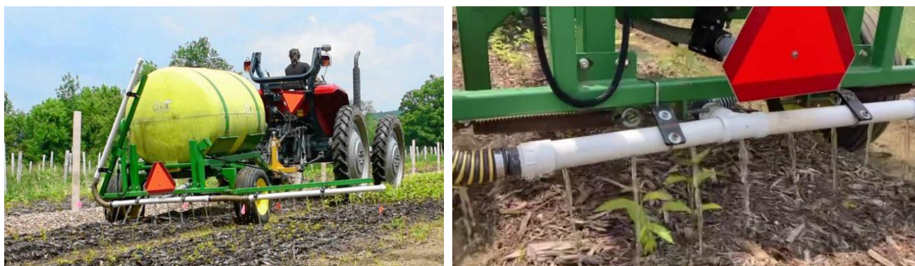
Figure 7: Photos de l'épandeur à urine stabilisée auto-construit du Rich Earth Institute, en cours d'utilisation. Source : Rich Earth Institute.
