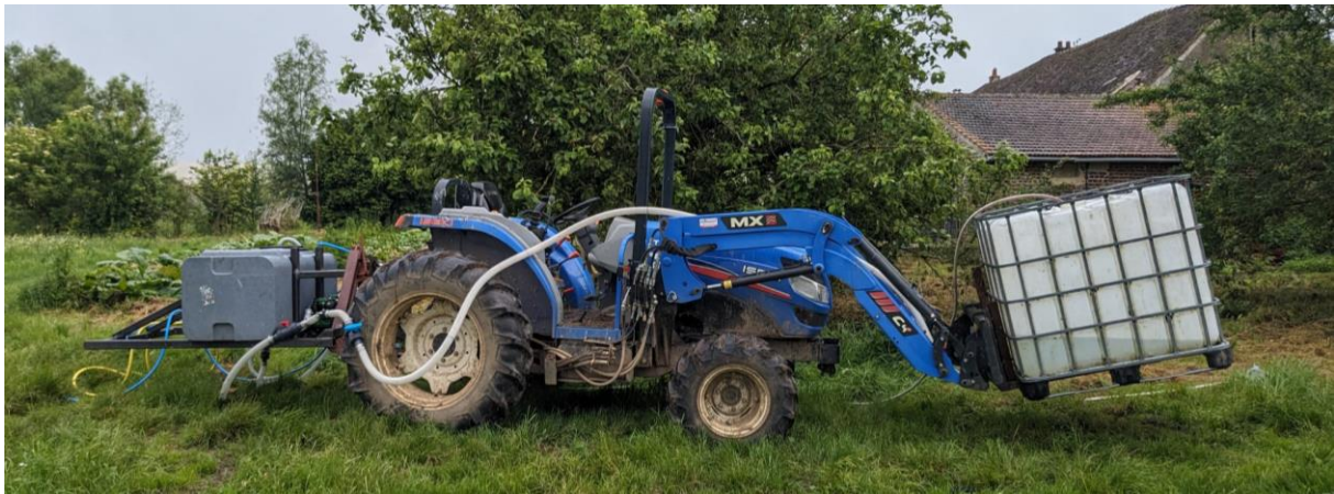
Figure 23: Exemple de cuve IBC à l'avant du tracteur
