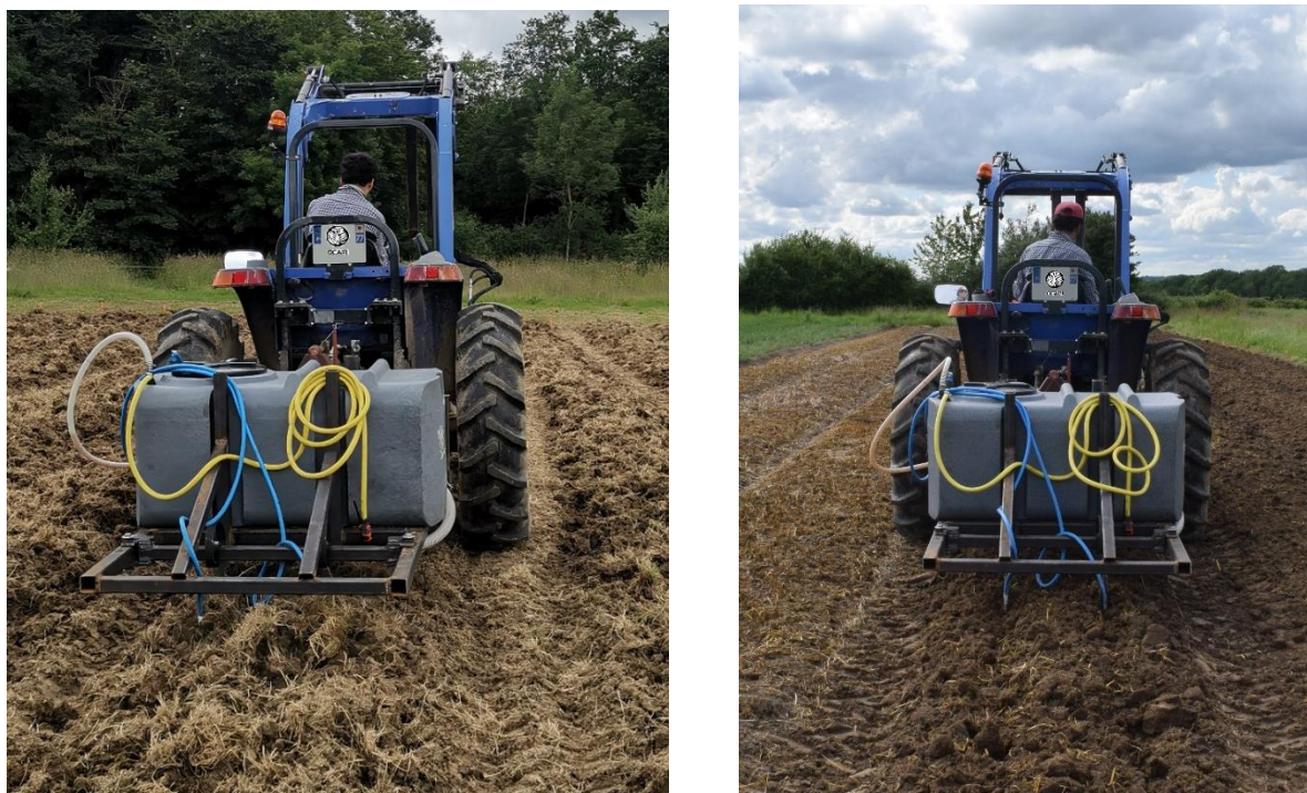
Figure 26 : A gauche, utilisation de l'outil sur un sol préparé grossièrement (beaucoup de grosses mottes et de résidus) : les sillons ne se refermaient pas d'eux-mêmes après le passage des dents et nous avons constaté de la volatilisation (odeurs). A droite, sol préparé de façon assez fine, les sillons se refermaient d'eux-mêmes et nous avons observé peu de volatilisation (peu d'odeurs).
