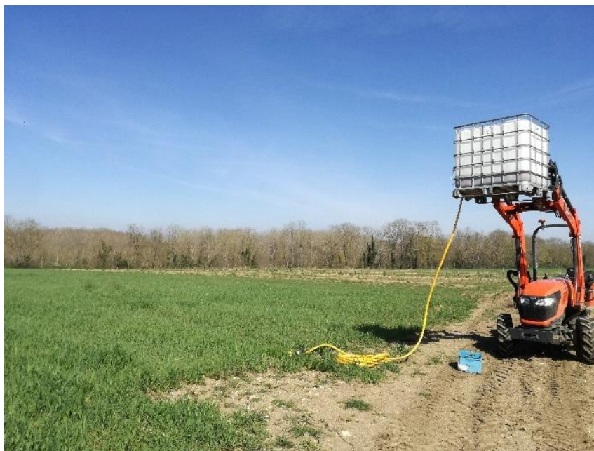
Figure 17: utilisation des fourches du tracteur pour embarquer le volume de lisain (alternative à la cuve intégrée à l'outil)
