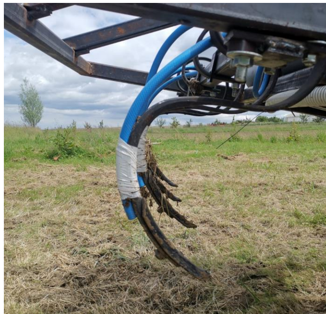
Figure 18 Dents de vibroculteur avec le tuyau d'arrivée de Lisain (qui peut être fixé plus bas que sur cette photo)
