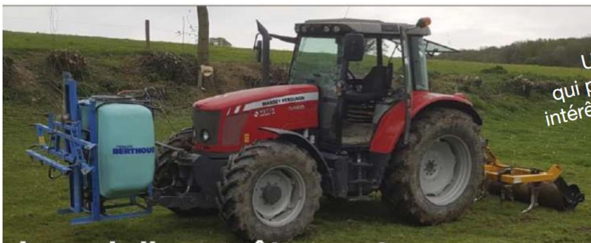
Figure 8 : Fissuration de pâture et injection de ferments avec une machine modifiée. Crédit P.S Calvados / Ulrich Schreier (Schreier 2021)
