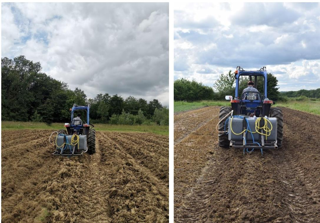
Figure 19: A gauche, utilisation de l'outil sur un sol préparé grossièrement : les sillons ne pouvaient se refermer d'eux-mêmes et nous avons constaté de la volatilisation (odeurs). A droite, sol préparé de façon assez fine, les sillons se refermaient d'eux-mêmes après passage des dents et nous avons observé peu d'odeurs.
