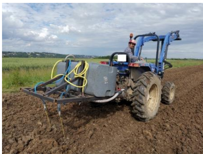
Figure A2-5 : Épandage de lisain au champ, en injection dans le sol travail avec pipiculteur
