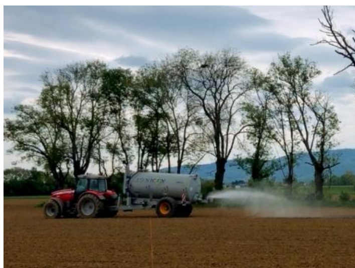
Figure A2-9 : Épandage de lisain au champ à la tonne à lisier avec une buse-palette
