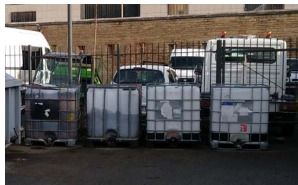
Plateforme de stockage temporaire d'urine en cuve IBC dans l'enceinte d'un atelier municipale des espaces verts de la ville de Lyon
