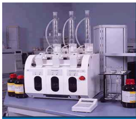
Figure II.8 : Extraction des hydrocarbures par micro-ondes (Soxwave)
