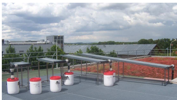
Figure 6: Dispositif "Flûte de pan" testant les différentes longueurs (à gauche) et Pyramides permettant d'appréhender l'effet de l'inclinaison (à droite)
