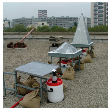
Figure 6: Dispositif "Flûte de pan" testant les différentes longueurs (à gauche) et Pyramides permettant d'appréhender l'effet de l'inclinaison (à droite)
