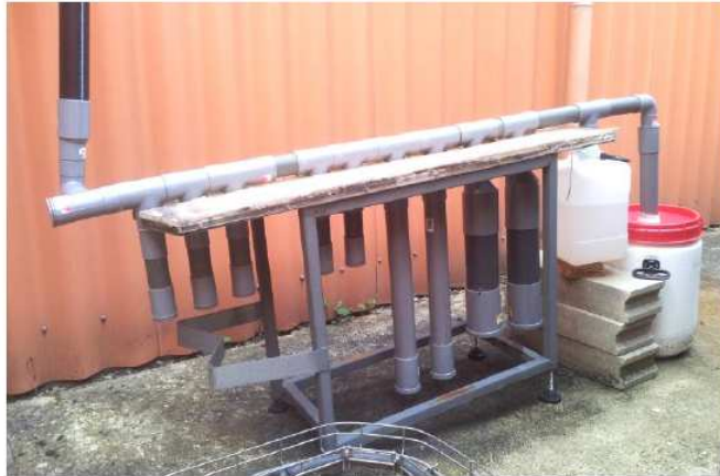
Figure 1 – système d'échantillonnage fractionné des eaux de ruissellement mis en place au niveau d'un banc d'essai en zinc
