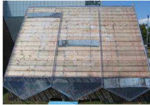
Figure 1 – bancs d'essais de matériaux d'étanchéité en plomb mis en œuvre au CSTB
