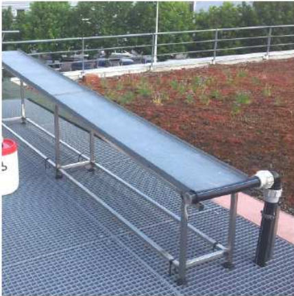
Figure 1 – système d'échantillonnage fractionné des eaux de ruissellement mis en place au niveau d'un banc d'essai en zinc
