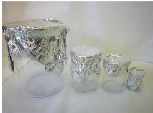
Figure 8 : Nettoyage et protection de la verrerie
