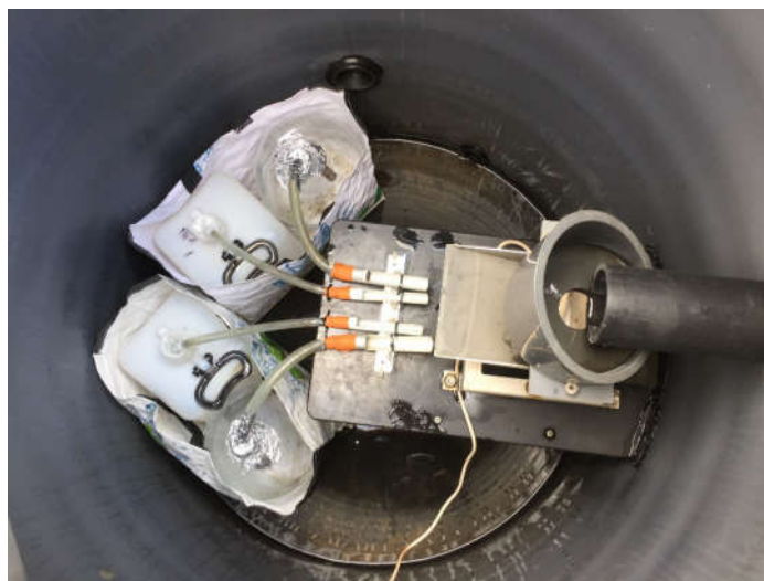
Figure 43: Système de fractionnement de l'eau dans la cuve de l'accotement filtrant
