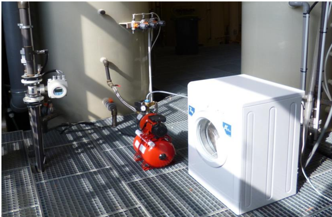
Figure 3 : Dispositif expérimental permettant l'alimentation d'un lave-linge par de l'eau de pluie
