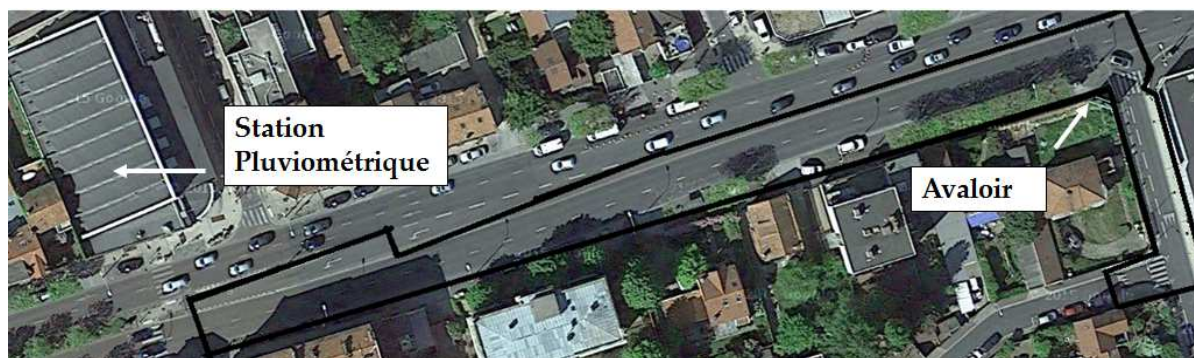
Figure 2-2 Le bassin versant routier délimité en noir et les localisations de la station de pluviométrique et de l'avaloir (Google Map@2016)
