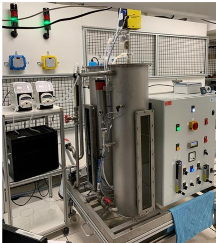
Figure 8 : Pilote d'ozonation avec la glacière utilisée (à gauche en noir) pour l'ajout des réactifs.
