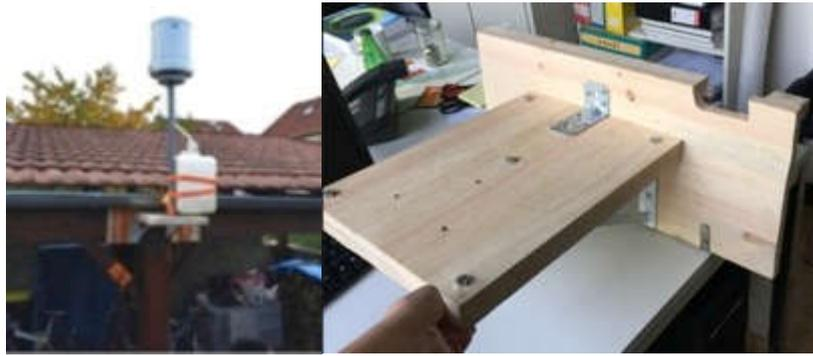
Figure 3-19. Photographies du pluviomètre et du plateau du pluviomètre du site de Romainville
