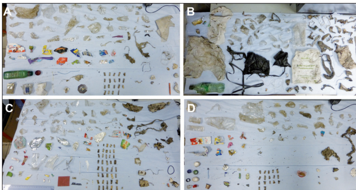
Figure 5. Objets trouvés fréquemment : dégrilleur S_{6cm} (A et B) et dégrilleur S_{1cm} (C et D)
